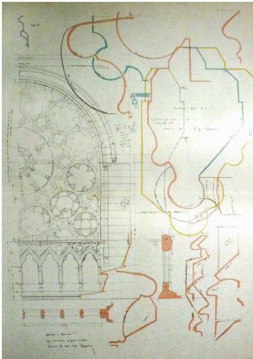
Figura 12. E.E. Viollet-le-Duc, Clermont-Ferrand, disegno del rosone occidentale della Cattedrale e profili di modanature (da Compositions et dessins de Viollet-le-Duc 1884).
